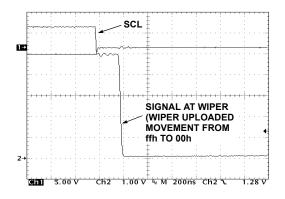
FIGURE 14. LARGE SIGNAL SETTLING TIME
