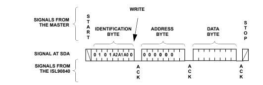
FIGURE 17. BYTE WRITE SEQUENCE
