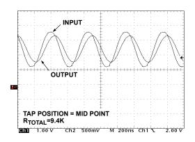
FIGURE 12. FREQUENCY RESPONSE (2.2MHz)
